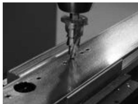
Markierungsbohrungen für Drücker und Zylinder aufbohren Forage des perçages de marquage pour poignée et cylindre Drill out the marking holes for the handle and cylinder
