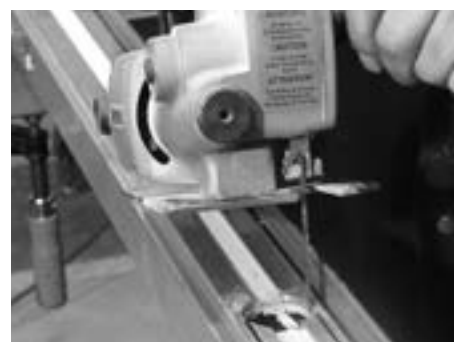
Ausnehmung mit Stichsäge ausschneiden Découpage de l'évidement avec un scie à guichet Cut out the recess using a jigsaw
