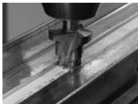
Für die rückseitige Ausnehmung bis zum Anschlag bohren Forer à fond pour l'évidement en face arrière For the recess on the reverse side, drill as far as the end stop
