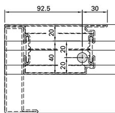
Zuschnitt Jochhöhe - 35 mm / Découpe hauteur du cadre dormant - 35 mm / Cutting yoke height - 35 mm / Jochhöhe / Hauteur du cadre dormant / Yoke height
