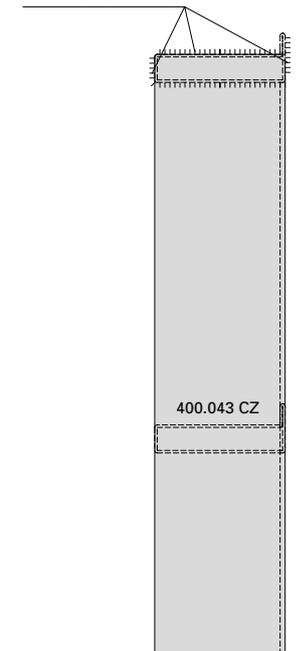
Einbau Labyrinthprofil in Rahmen
