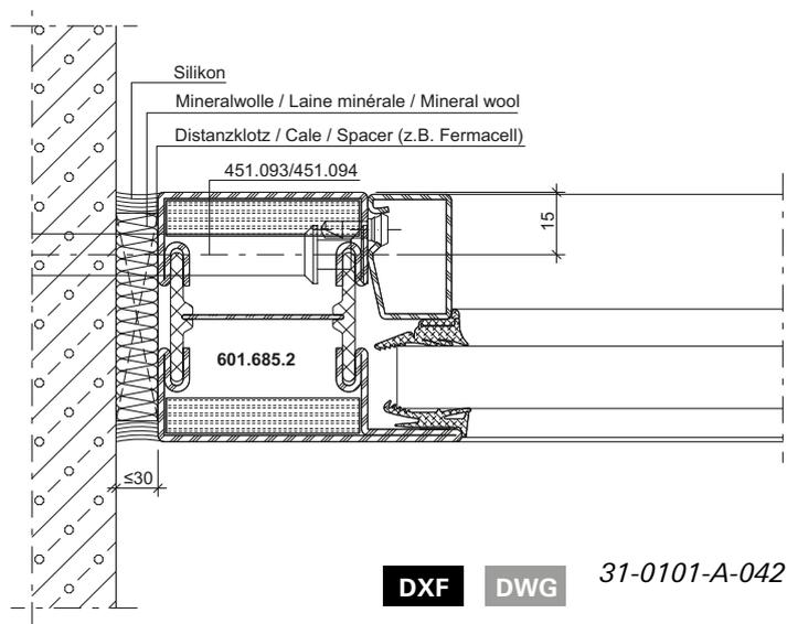
Anschlüsse am Bau im Masstab 1:2
