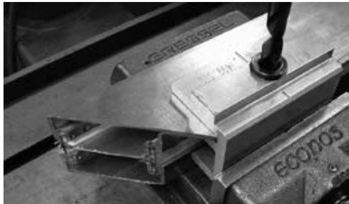
Bohren mit Ständer-Bohrmaschine
