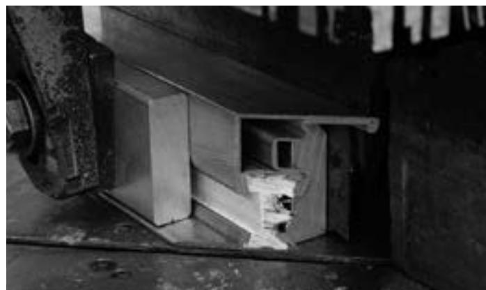
Zuschnitt mit Einspannunterlagen (Flügelprofil)
