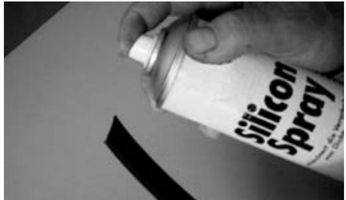
Dichtungen mit Silikon besprühen
