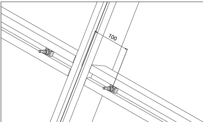
Abb. 24 1 Traganker pro Seite für  $Q < 75 \text{ kg}$
