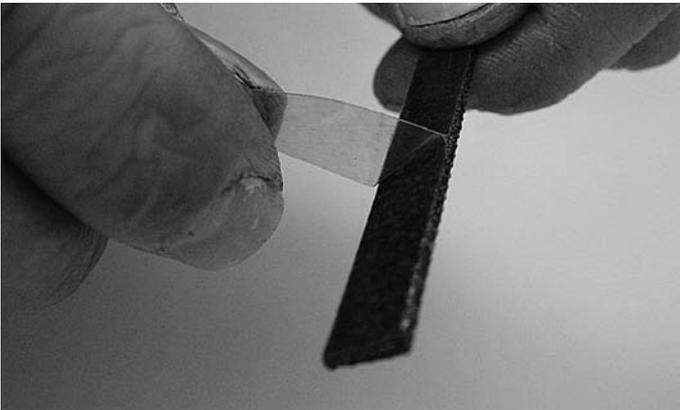
**Abb. 83** *Schutzfolie bei Brandschutzlaminat-Streifen ein Stück weit abziehen*
