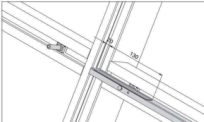
Abb. 4 Lage Glasklotzlager bei  $Q < 75$  kg
