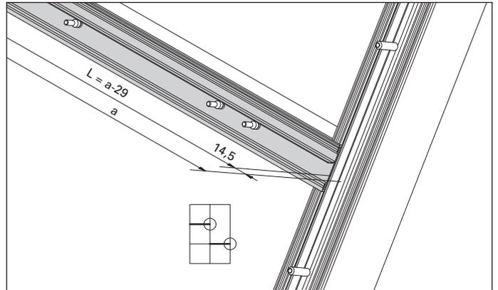
Abb. 44 Die Horizontaldichtung wird im Kreuzpunkt-Bereich zwischengesetzt (kein Untermass)
