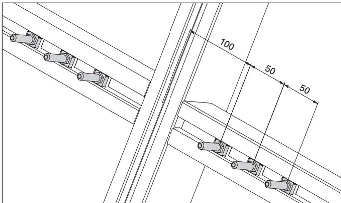
Abb. 7 3 Traganker pro Seite für  $Q > 150 - 300$  kg
