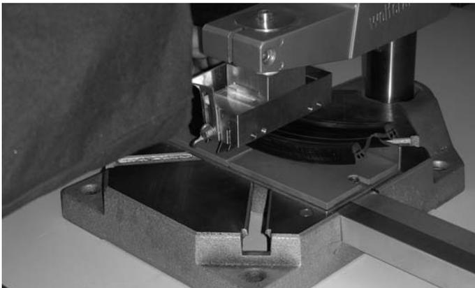
Abb. 46 Dichtung mit Stanze ablängen
