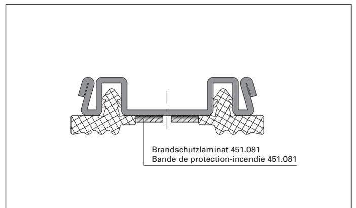
**Abb. 76** Abschliessend Schutzfolie weiter abziehen und Brandschutzlaminat-Streifen fortlaufend andrücken.
