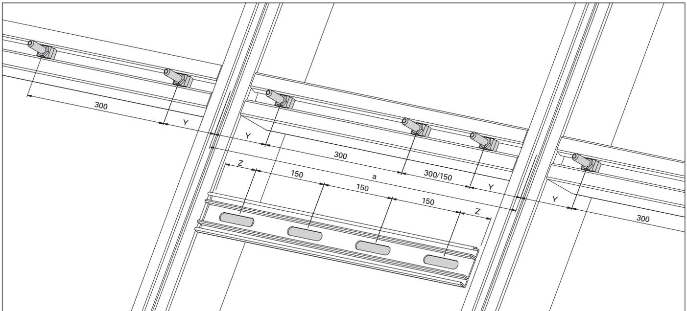
Abb. 4 Die weiteren Brandschutzanker folgen im Abstand von 300 mm.
