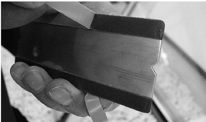
**Abb. 94** Schutzfolie von Klebeband abziehen
