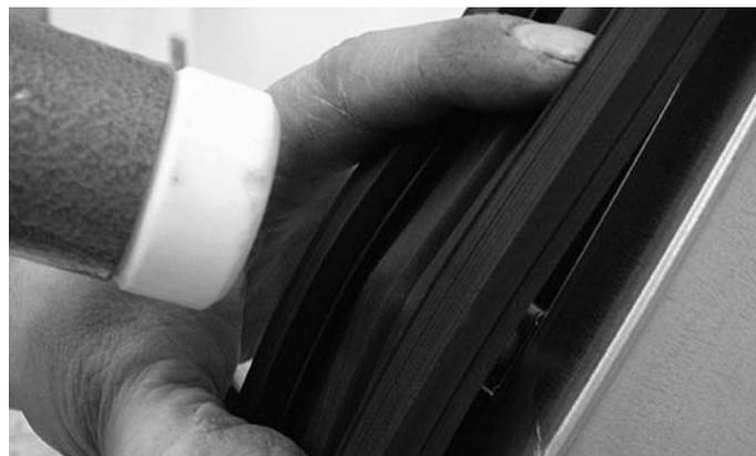
Abb. 30 Zentrierung durch Führungsnute auf Rückseite der Dichtung
