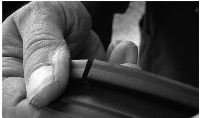
Abb. 47 Abgelängte und gleichzeitig rückseitig eingeschnittene Riegeldichtung
