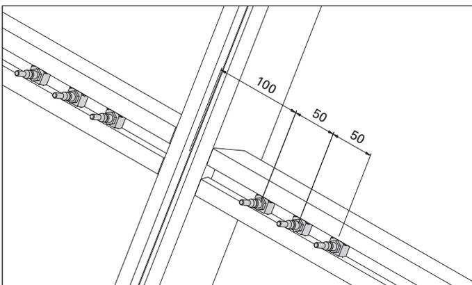
Abb. 26 3 Traganker pro Seite für  $Q > 150 - 300 \text{ kg}$
