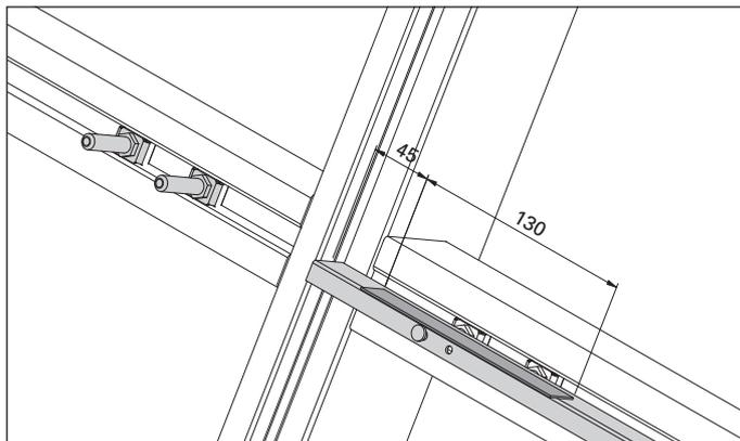
Abb. 6 Lage Glasklotzlager bei  $Q > 75 - 150$  kg
