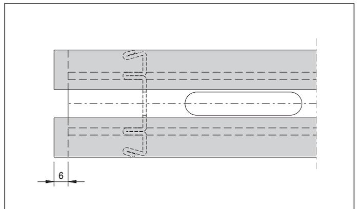
Abb. 14a Einbau-Situation der Keramikfaserbänder bei Anpressprofilen
