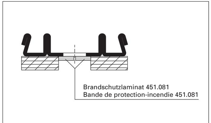
Abb. 17 Abschliessend Schutzfolie weiter abziehen und Brandschutzlaminat-Streifen fortlaufend andrücken.
