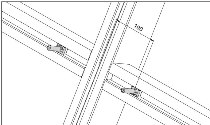
Abb. 3 1 Traganker pro Seite für  $Q < 75$  kg
