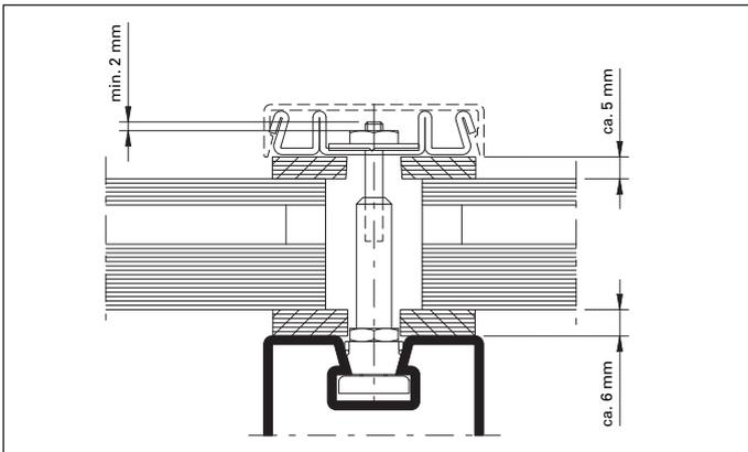
Abb. 28 Schraubenüberstand 2 mm, Distanzbänder in gedrückter Situation
