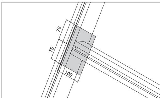
Abb. 16 Zone ohne Brandschutzanker im Rand-Bereich
