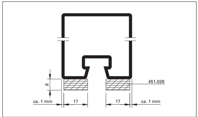
**Abb. 8** Klebefolie beim Keramikfaserband abziehen
