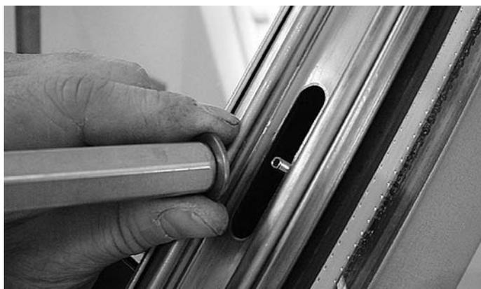
Abb. 98 Zentriermutter aufsetzen
