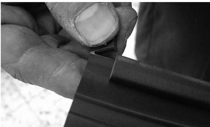
Abb. 48 Dichtungsteil auf Rückseite abreißen
