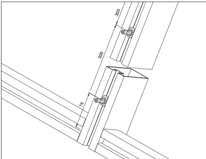
**Abb. 20** Die weiteren Brandschutzanker folgen im Abstand von 300 mm
