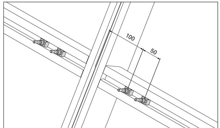
Abb. 25 2 Traganker pro Seite für  $Q > 75 - 150 \text{ kg}$
