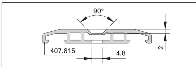
Abb. 27a Situation Bohrung / Ansenkung bei Riegel-Anschraubprofil
