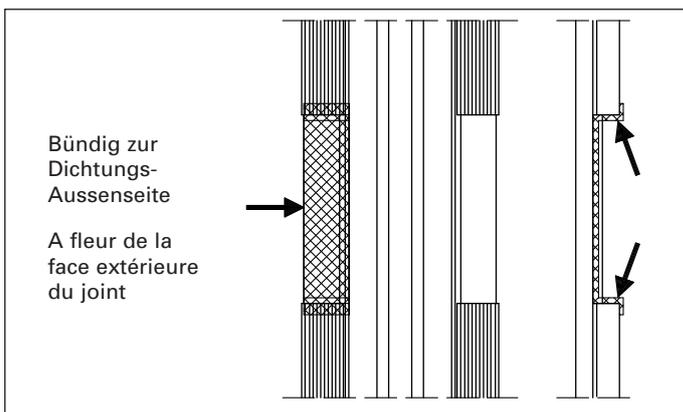
Abb. 56 Butyl-Dichtstück U-förmig eindrücken
