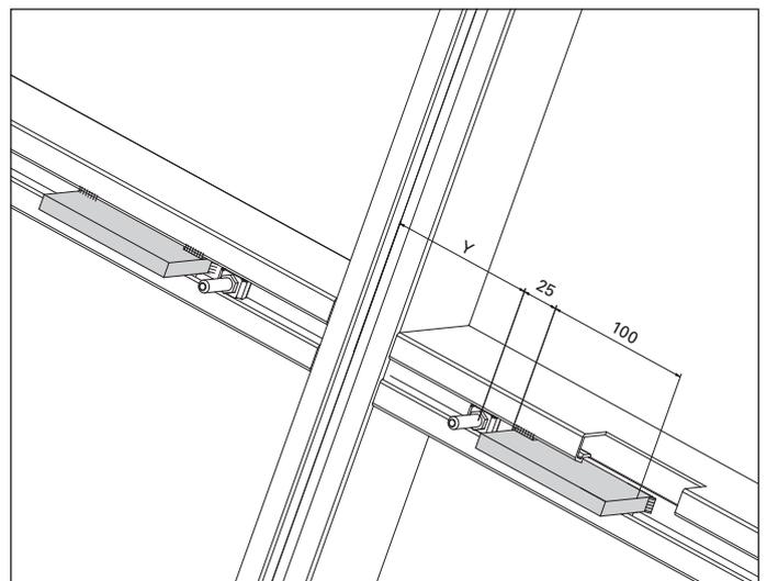
Abb. 6 Spezial-Glasauflage (Q 180-300 kg) gefertigt aus Flachstahl 100x10 mm, im Bereich VISS-Nute eingeschweisst (siehe Abb. 7).
