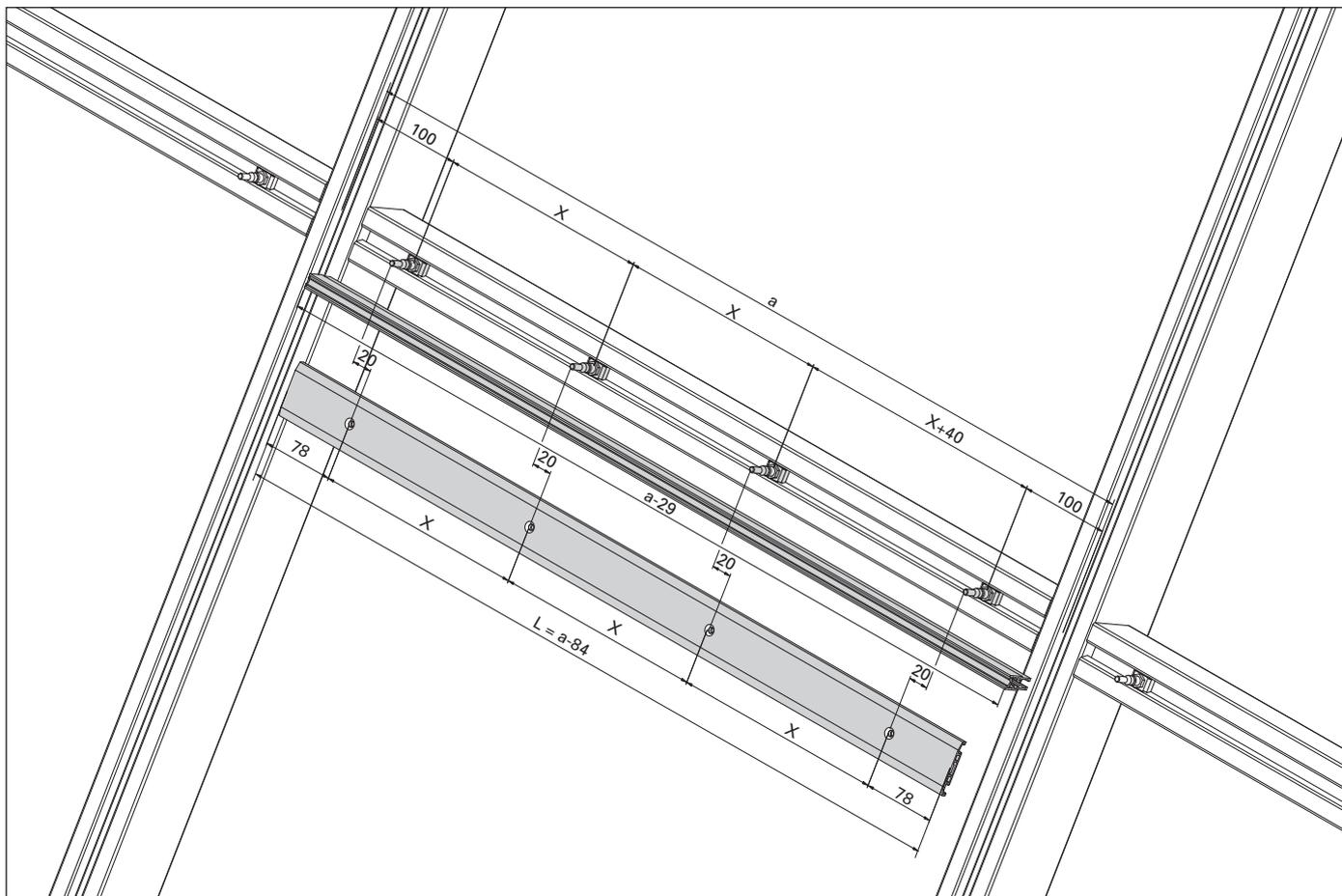
Abb. 27 Zuschnitt und Bearbeitung Riegel-Falz- und Anschraubprofile
