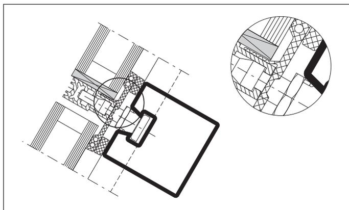
Abb. 90 Seitliche Entwässerung muss gewährleistet sein
