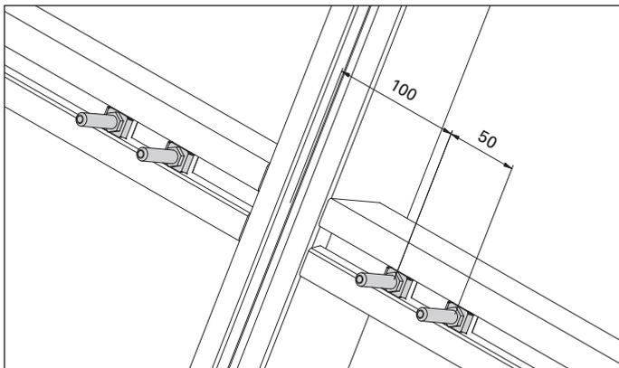
Abb. 5 2 Traganker pro Seite für  $Q > 75 - 150$  kg
