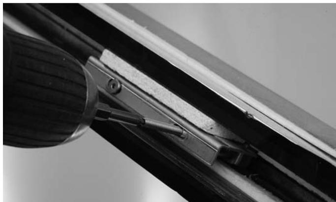
**Abb. 24** Eindrehen Gewindestifte bei Glasauflagen
