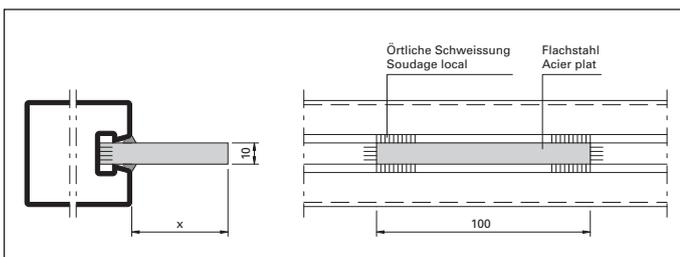
Abb. 7 Einbausituation Spezial-Glasauflage
