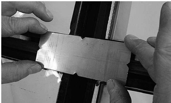
**Abb. 95** Dichtungsplatte im Kreuz- oder Endpunkt zentrieren und fest andrücken
