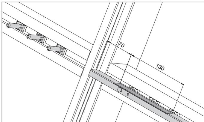
Abb. 8 Lage Glasklotzlager bei  $Q > 150 - 300$  kg
