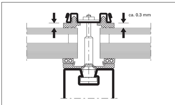
Abb. 100 Pressung der Vertikal-Dichtung ca. 0,3 mm
