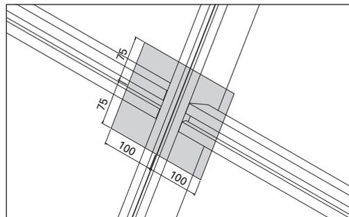
Abb. 17 Zone ohne Brandschutzanker im Kreuzpunkt-Bereich
