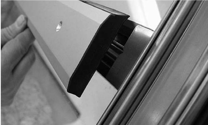
Abb. 104 Riegel-Anschraubprofil seitlich ausrichten
