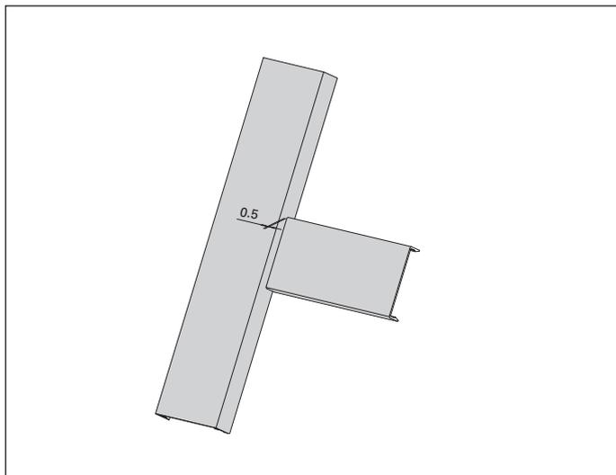
Abb. 2 Stoss der Riegelabdichtung Pfosten/Riegel
