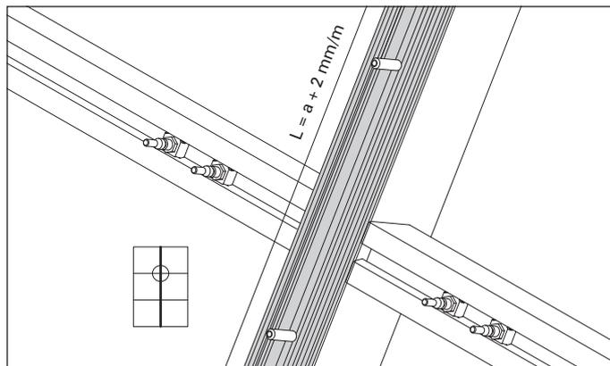
Abb. 28 Zuschnitt der Vertikaldichtung
