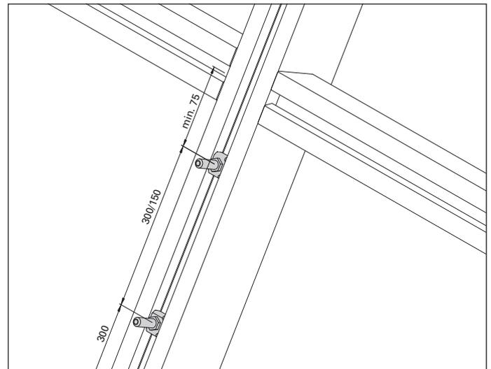
**Abb. 21** Abstand auf 150 mm reduzieren, damit die Freizone von 75 mm ab Riegelachse eingehalten wird
