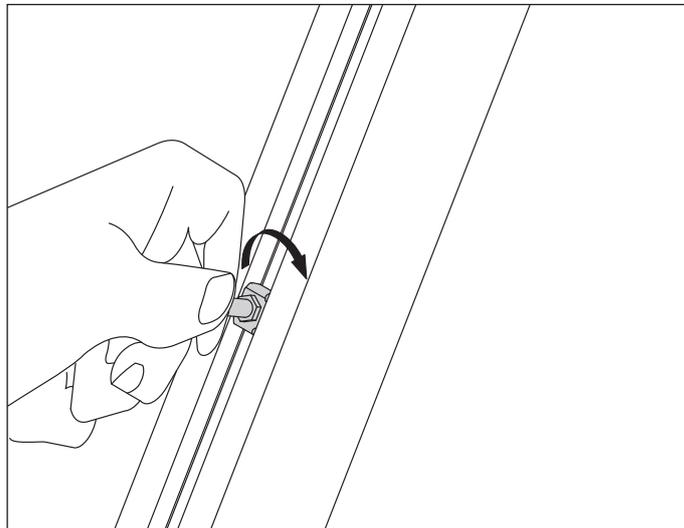
**Abb. 13** Mit einer Rechtsdrehung wird der Brandschutzanker fixiert
