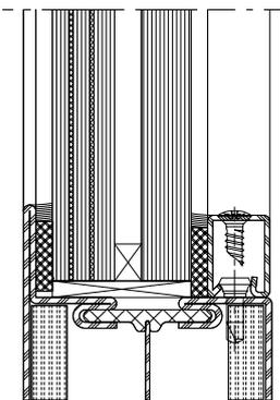
Einbau mit Aluminium-Glasleiste
