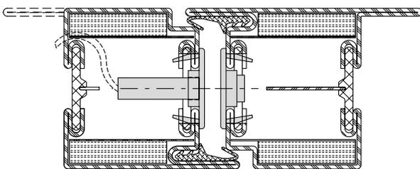
Der Magnetkontakt ist mittels Kleb- und Dichtmasse 450.096 im Montage teil zu fixieren. Die Verarbeitungsvorschriften des Herstellers sind zu beachten.
