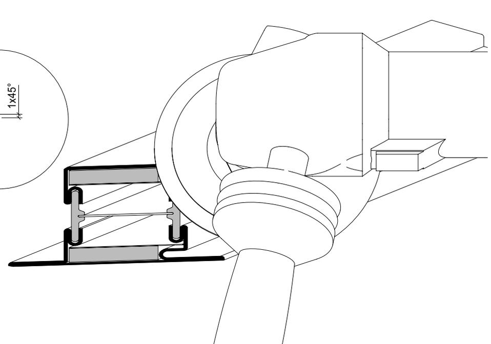
Profile im Schweißnahtbereich mit Winkelschleifer leicht anschärfen
