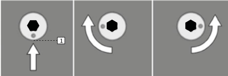
Auf der Exzentrerschraube befindet sich eine Markierung (1). Im Auslieferungszustand befindet sich die Seitenverstellung in Neutralposition.
