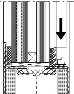
400.021 Z mit aufgeklebtem Distanzband montieren, abwechselnd mit 450.023 und 555.486 befestigen.
