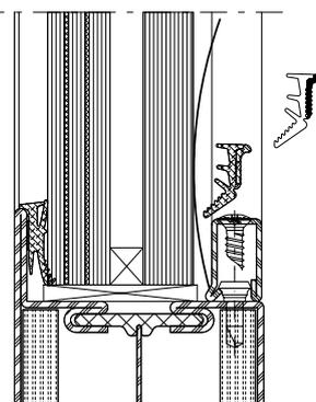
Dünne Stahlbleche (z.B. 0,15 mm) erleichtern das Eindrücken der Dichtungen im Bereich der Glasklötze.
