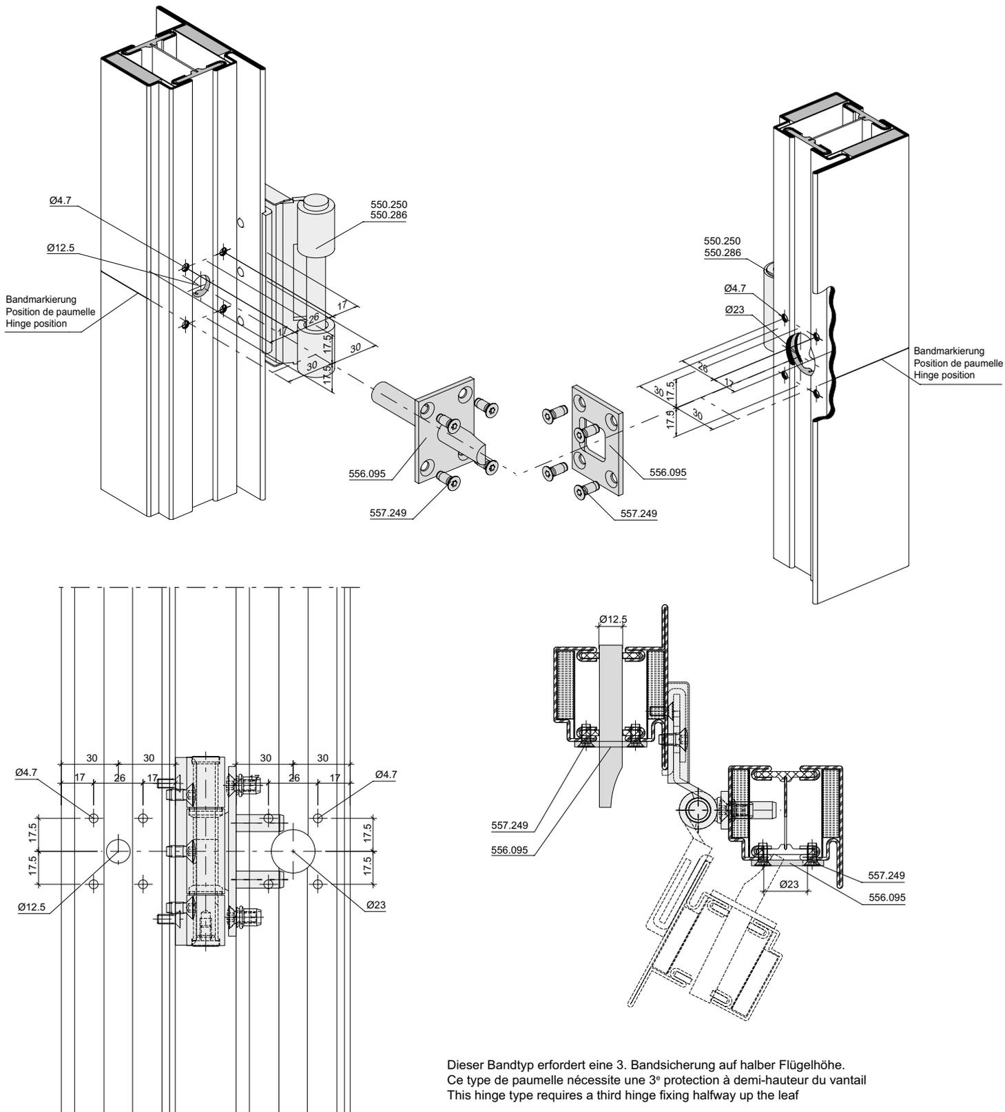
Dieser Bandtyp erfordert eine 3. Bandsicherung auf halber Flügelhöhe.
