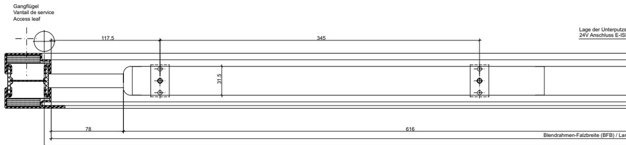
Abbildung: ISM-Gleitschiene schmaler SF für Boxer, mit Hebel, silberfarbig 597.061
