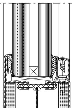
Detail Dichtung fertig eingebaut
