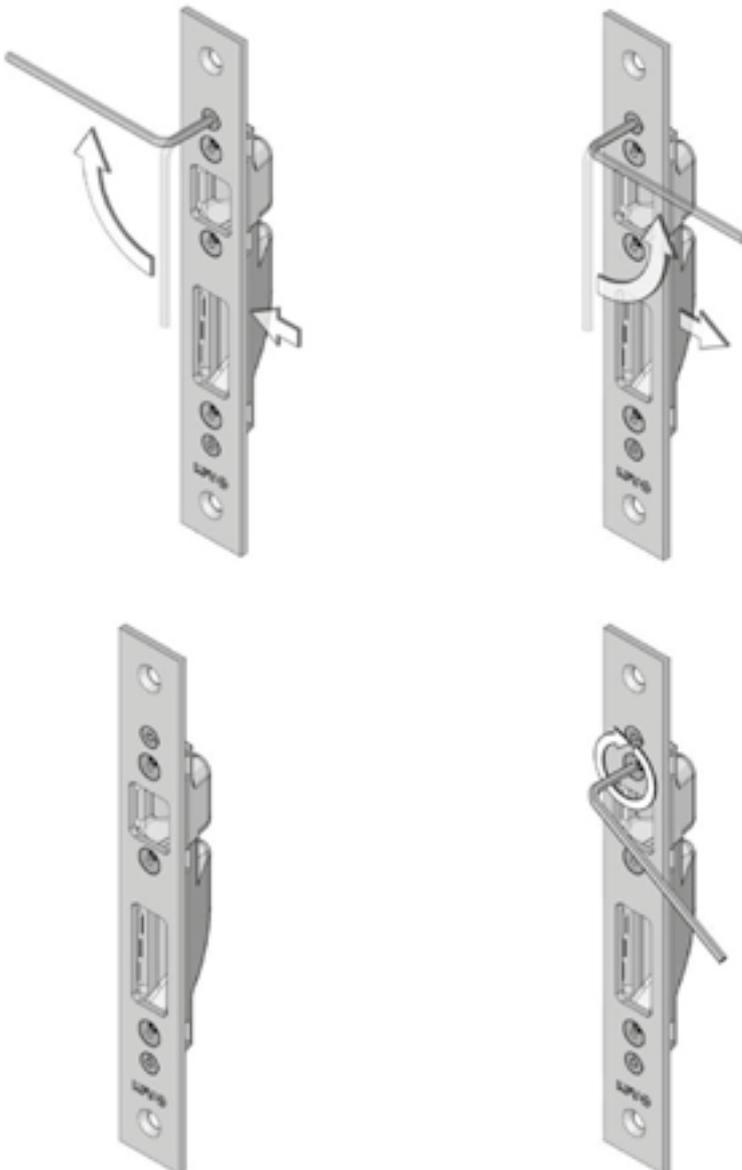
Drehen Sie die Exzenter bis zu 90° nach rechts bzw. links. In 90° Stellung ist der max. Verfahrweg der Q-Verstellung erreicht.
