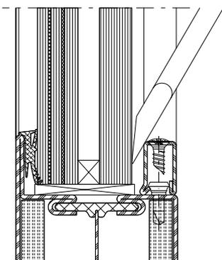
Glaselement mittels Klotzungshebel vorsichtig an die äussere Anschlagdichtung drücken.
