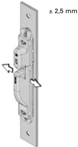
Die Hinterfütterungen der Schliessbleche sind seitlich verstellbar. Bei Panikmehrfachverriegelungen dürfen die Verriegelungselemente keinen seitlichen Druck auf die Rahmenteile ausüben. Die Verriegelungselemente müssen leichtgängig in Verriegelungs- und Entriegelungsposition fahren.
