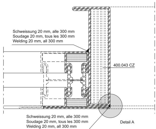
Einbau Labyrinthprofil in Schiebeflügel für einflügelige Schiebetüren
