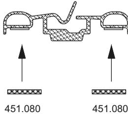
Dichtung mit Selbstklebestreifen.
