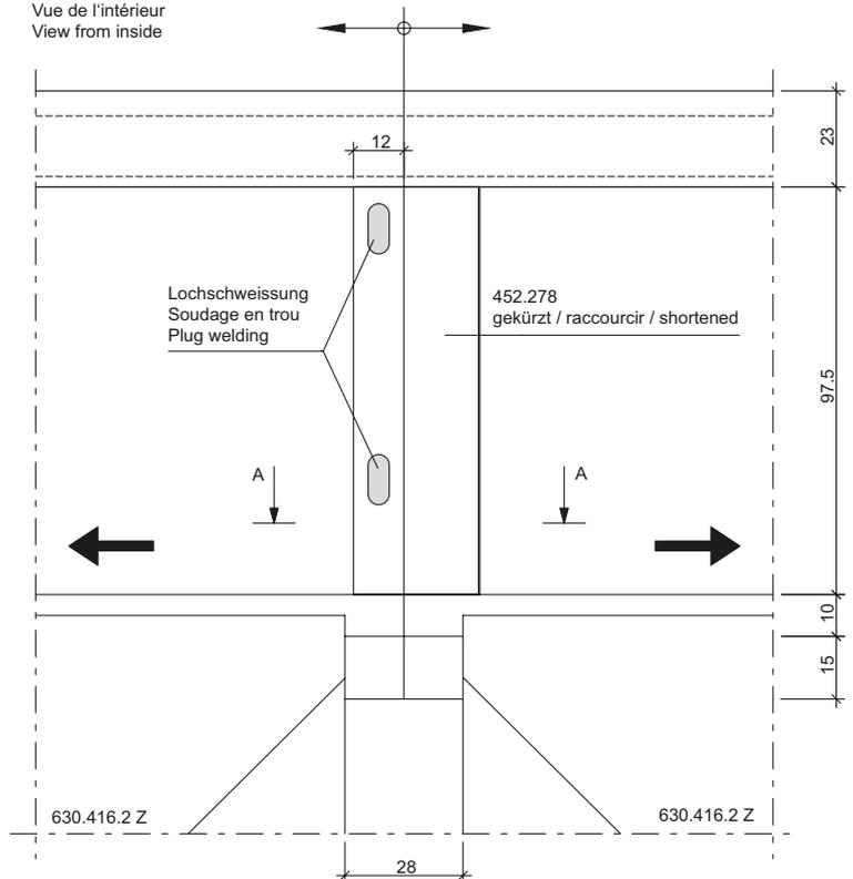
**Einbau Labyrinthprofil in Rahmen für einflügelige Schiebetüren**
