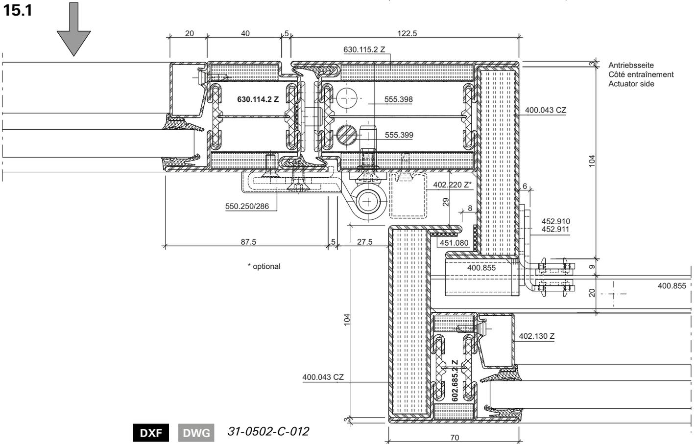
Schnittpunkte Schiebetüren Break-Out im Massstab 1:2
