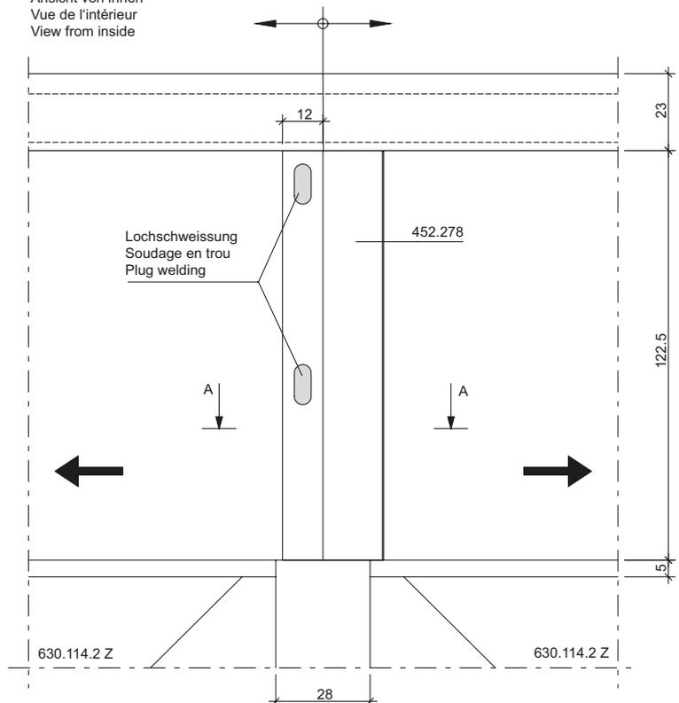
Einbau Stulpplatte bei
