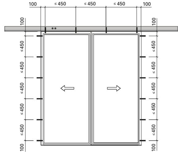
Gilt für alle zweiflügeligen Ausführungen mit/ohne integrierte Fluchttüre mit Seitenteilen (mit/ohne Oberlicht)
