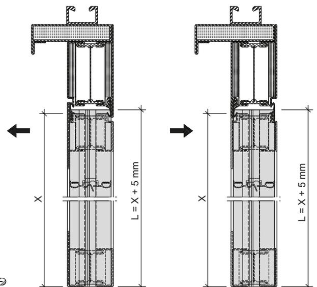
L = Einbaulänge Dichtung
