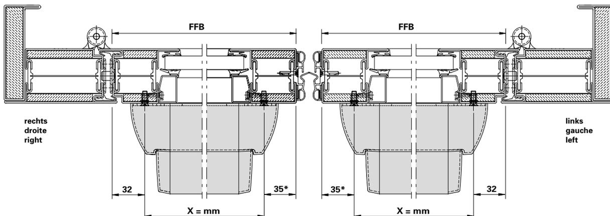
\* 32 mm bei aufgesetzter Schlossmontage
