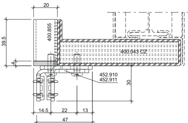
Schrauben zur Befestigung der Flügelführung 452.910 / 452.911 müssen mit Schraubensicherung fixiert werden.
