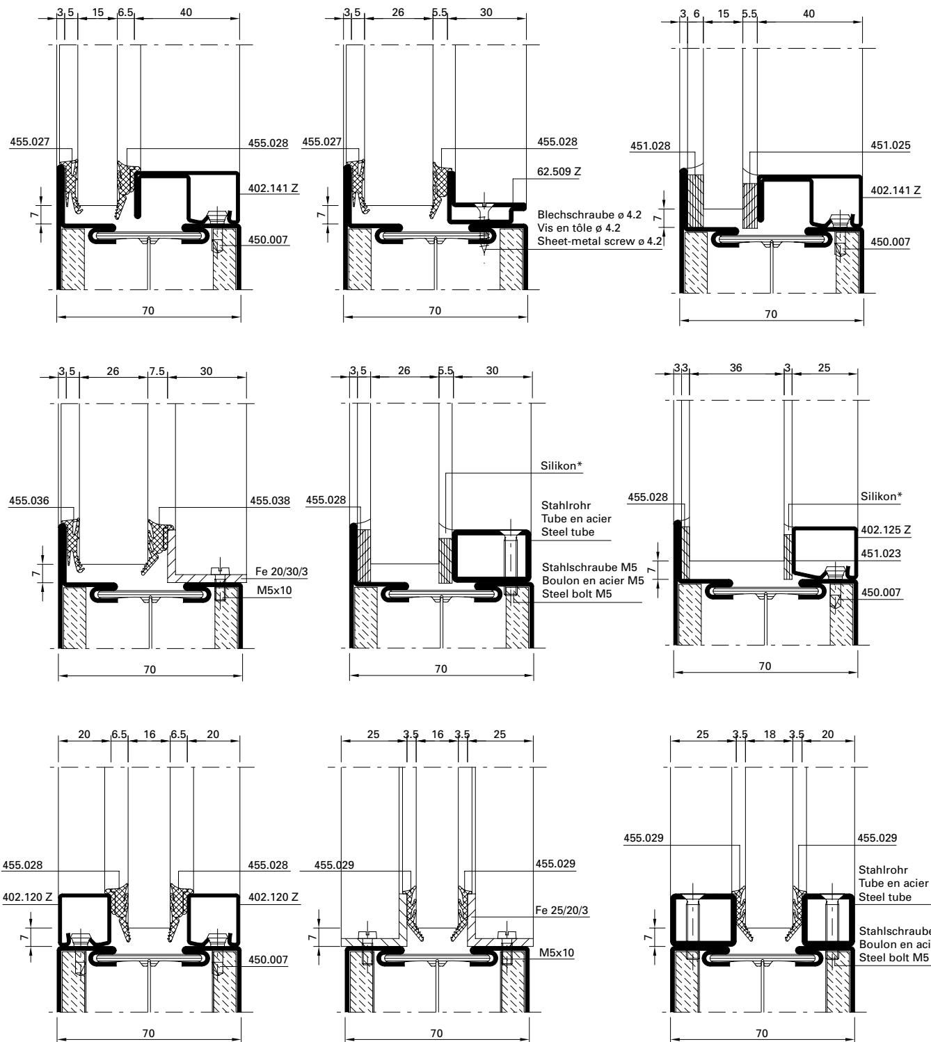
Bedingt durch verschiedene Toleranzen (Profile, Glasleisten, Anordnung Befestigungsknöpfe, Glasdichtungen resp. Papierfaserbänder und Glaselemente) empfehlen wir, die Wahl der Papierfaserbänder resp. Glasdichtungen vorgängig an einem Element zu prüfen.
