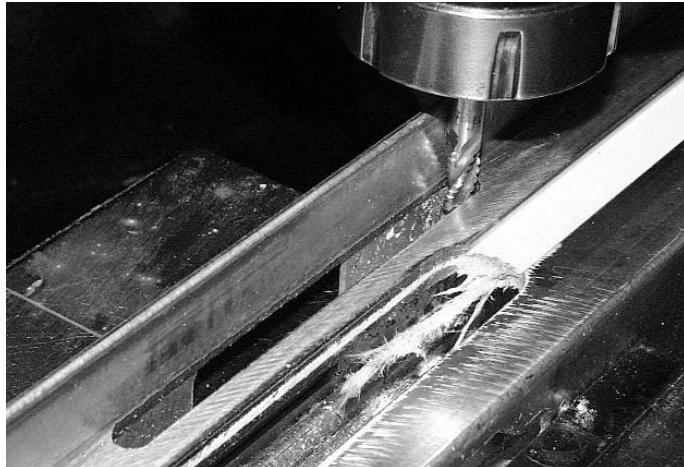
Abb. 7 Schlitz für Bohrschutzplatte
