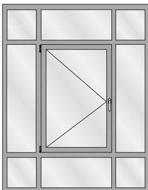
Einflügeliges Fenster in zugehöriger Tragkonstruktion
