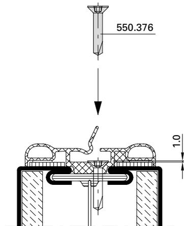
Dichtung mittels Schraube 550.376
