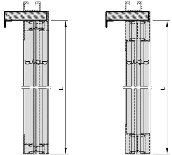
L = Einbaulänge Dichtung
