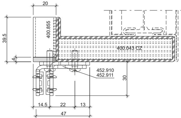
Schrauben zur Befestigung der Flügelführungsrolle 452.910 / 452.911 müssen mit Schraubensicherung fixiert werden.
