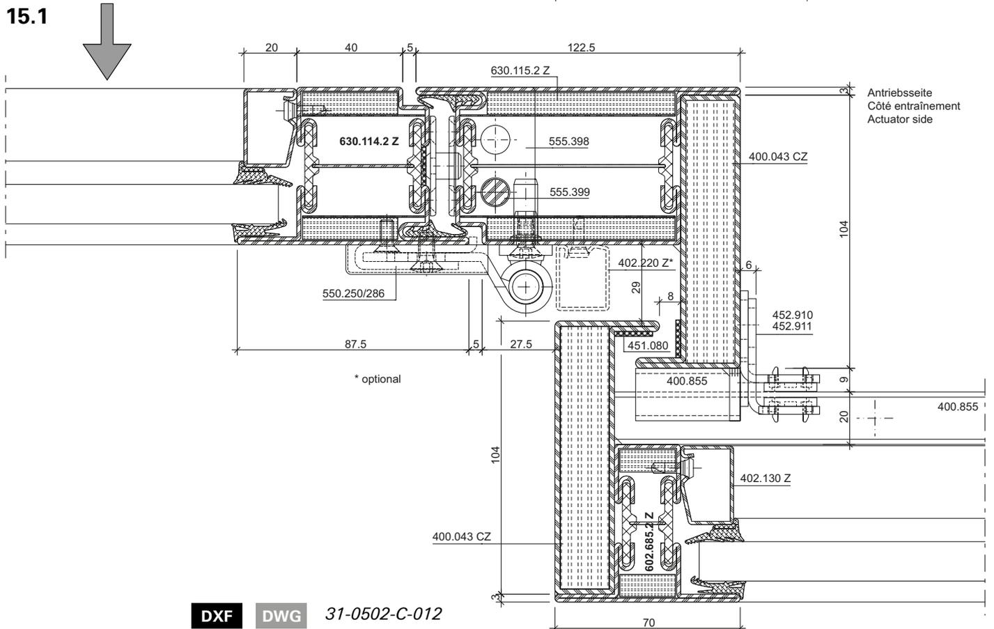
Schnittpunkte Schiebetüren Break-Out im Masstab 1:2
