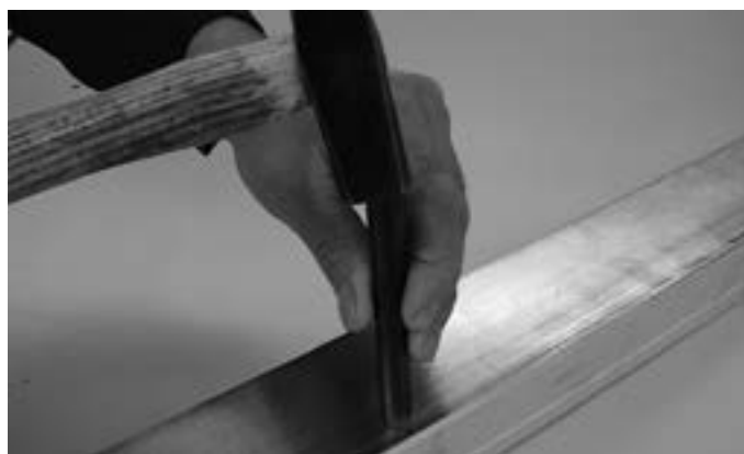
Einschlagen der Tülle mit Montagewerkzeug 499.318 und Stahlhammer (Achtung: Unterlagen verwenden)
