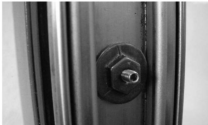
Abb. 33 M4-Spezial-Zentriermutter für die Montage der Anpressprofile. Überstand Gewindestift min. 2 mm.
