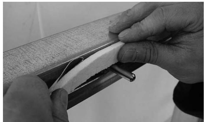
Abb. 2 Keramikfaserband auf Riegel setzen und andrücken
