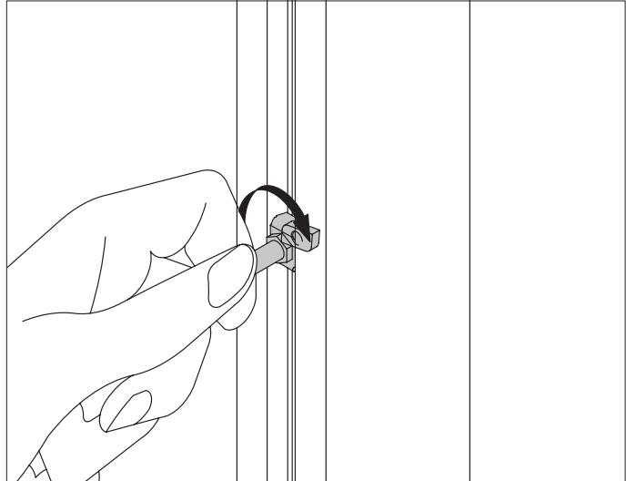
Abb. 29 Mit einer Rechtsdrehung wird der Brandschutzanker fixiert
