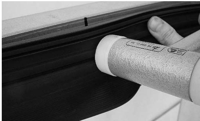
*Abb. 7 Aufschlagen der Dichtung mittels Nylonhammer
