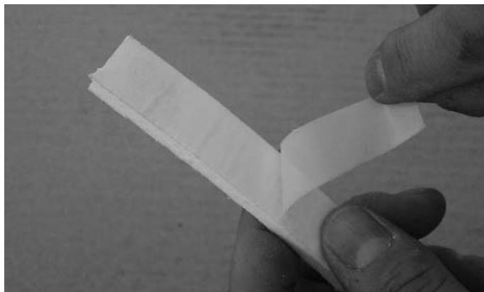
Abb. 1 Klebefolie beim Keramikfaserband abziehen
