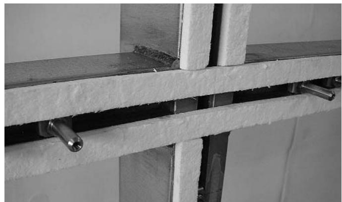
Abb. 6 *Die vertikalen Keramikfaserbänder werden im Kreuzpunkt-Bereich zwischengesetzt.*
