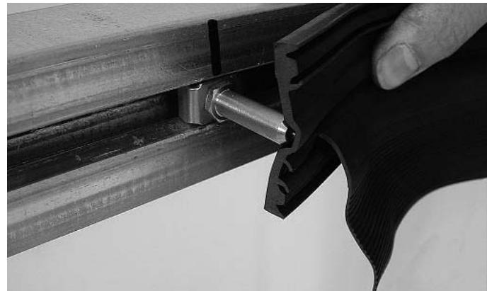
*Abb. 8 Zentrierung durch Führungsnuke auf Rückseite der Dichtung
