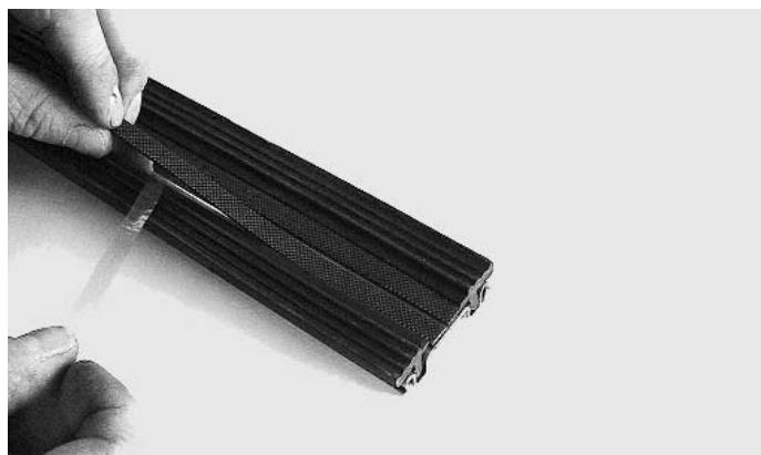
Abb. 46 Abschliessend Schutzfolie weiter abziehen und Brandschutzlaminat-Streifen fortlaufend andrücken.
