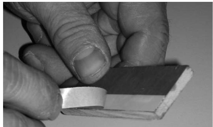
Abb. 88 Klebeband-Schutzfolie abziehen
