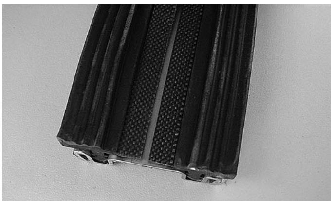
Abb. 76 Abschliessend Schutzfolie weiter abziehen und Brandschutzlaminat-Streifen fortlaufend andrücken.
