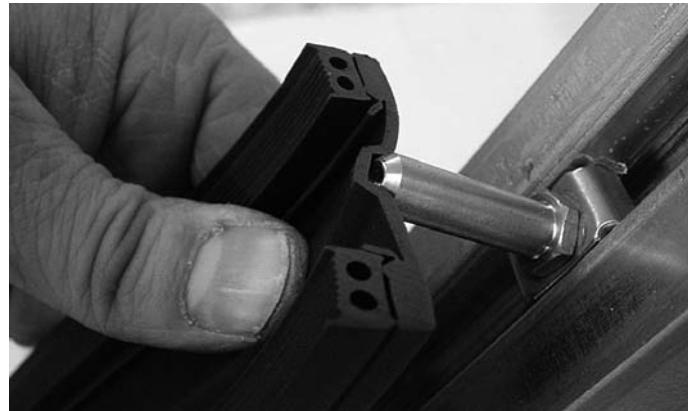
Abb. 30 Zentrierung durch Führungsnuute auf Rückseite der Dichtung
