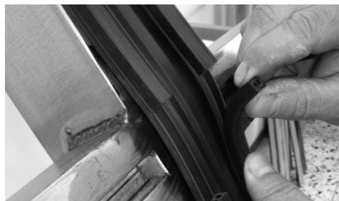
Abb. 37 Dichtungsteil abreißen
