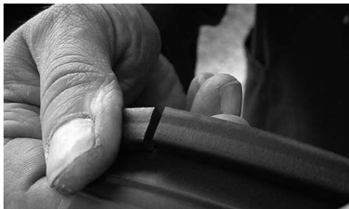
Abb. 47 Abgelängte und gleichzeitig rückseitig eingeschnittene Riegeldichtung
