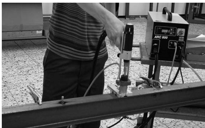
Abb. 7 Bolzen-Schweissgerät im Einsatz
