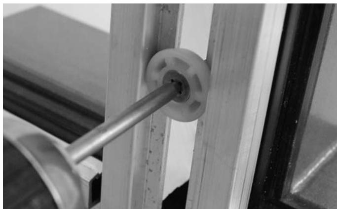
Abb. 29 SR1 Schraube M5 mit Zentrierscheibe mittels Akku-Bohrschrauber anziehen
