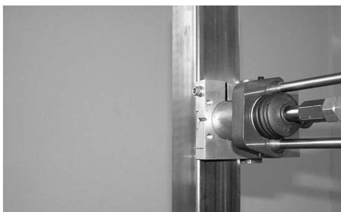
Abb. 13 Beim vertikalem Einsatz der Bolzenschweissung und bei starkem «Verblasen» des Schweißbades empfehlen wir als Hilfsmittel einen Keramikring einzusetzen
