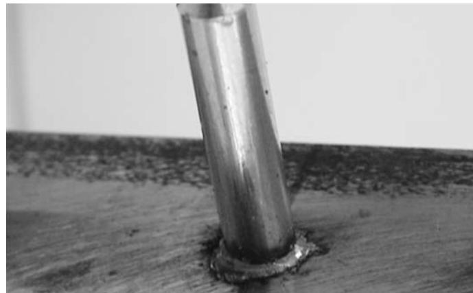
Abb. 10 Prüfung der Schweiß-Stelle durch Sichtkontrolle
