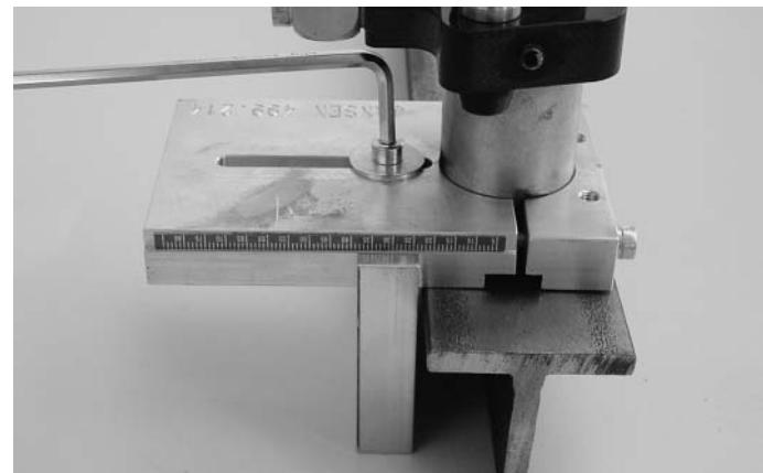
Abb. 4 Schweisslehre einstellen (Verstellbereich für Pfosten-Riegelbreiten von 40 – 130 mm)
