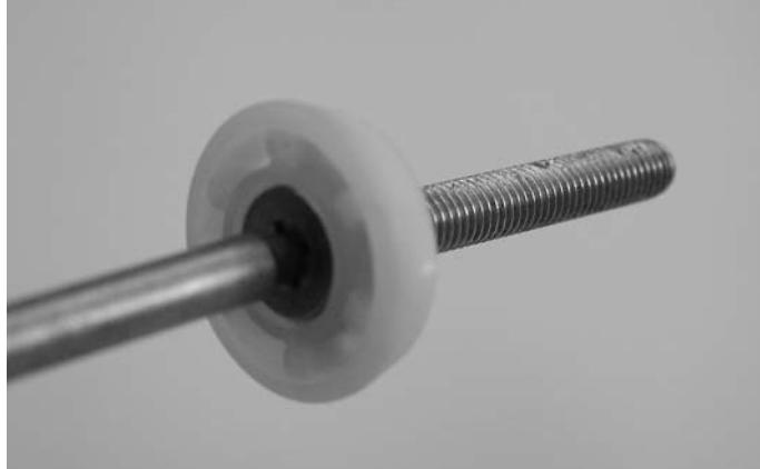
Abb. 27 SR1 schraube M 5 mit Zentrierscheibe auf Schraubklinge SR1 aufgesteckt
