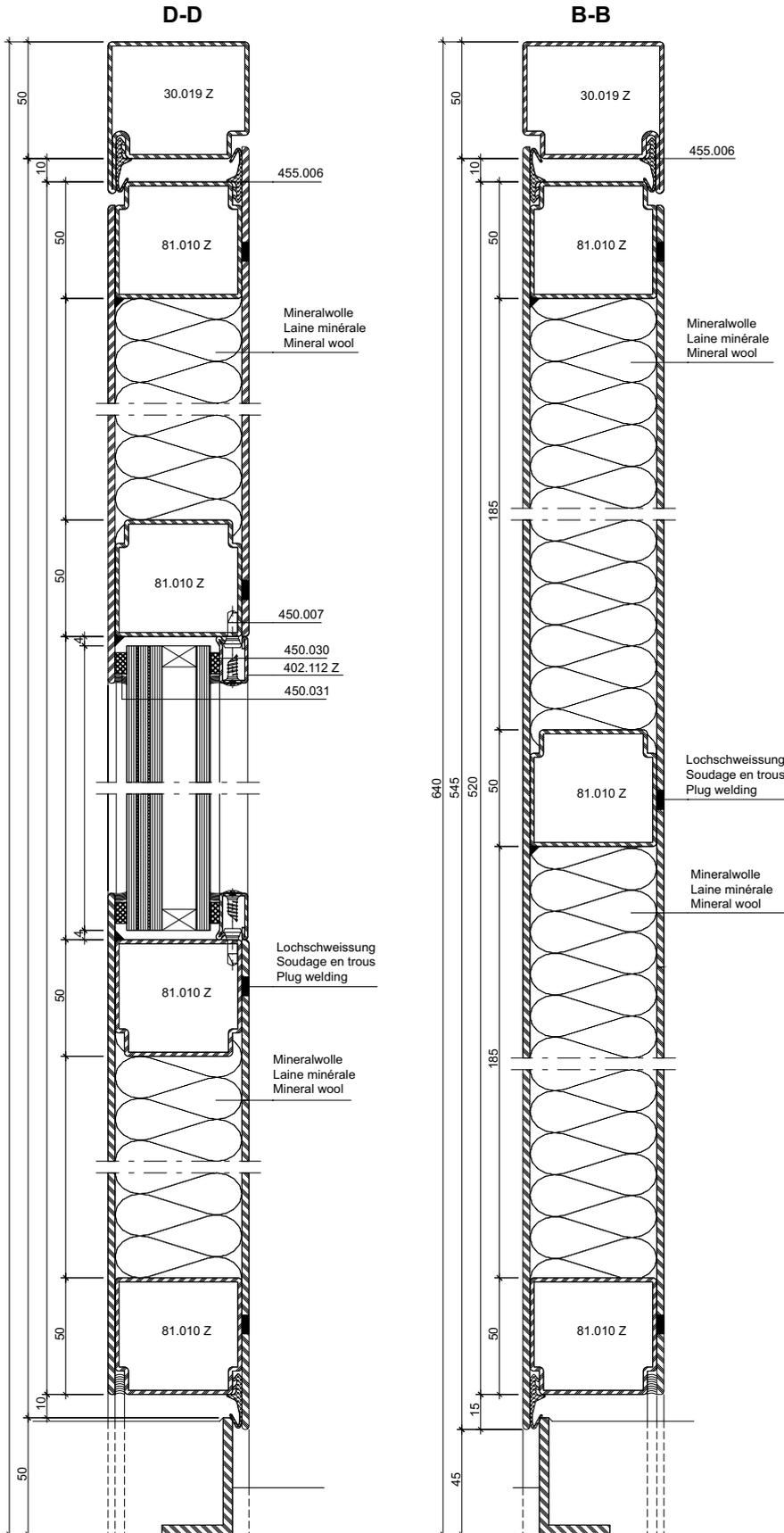
Aufgrund möglicher Deformationen von verblechten Türen in exponierten Lagen mit Sonneneinstrahlung sollte diese Anwendung nicht eingesetzt werden, ansonsten ist eine Beschattung vorzusehen.
