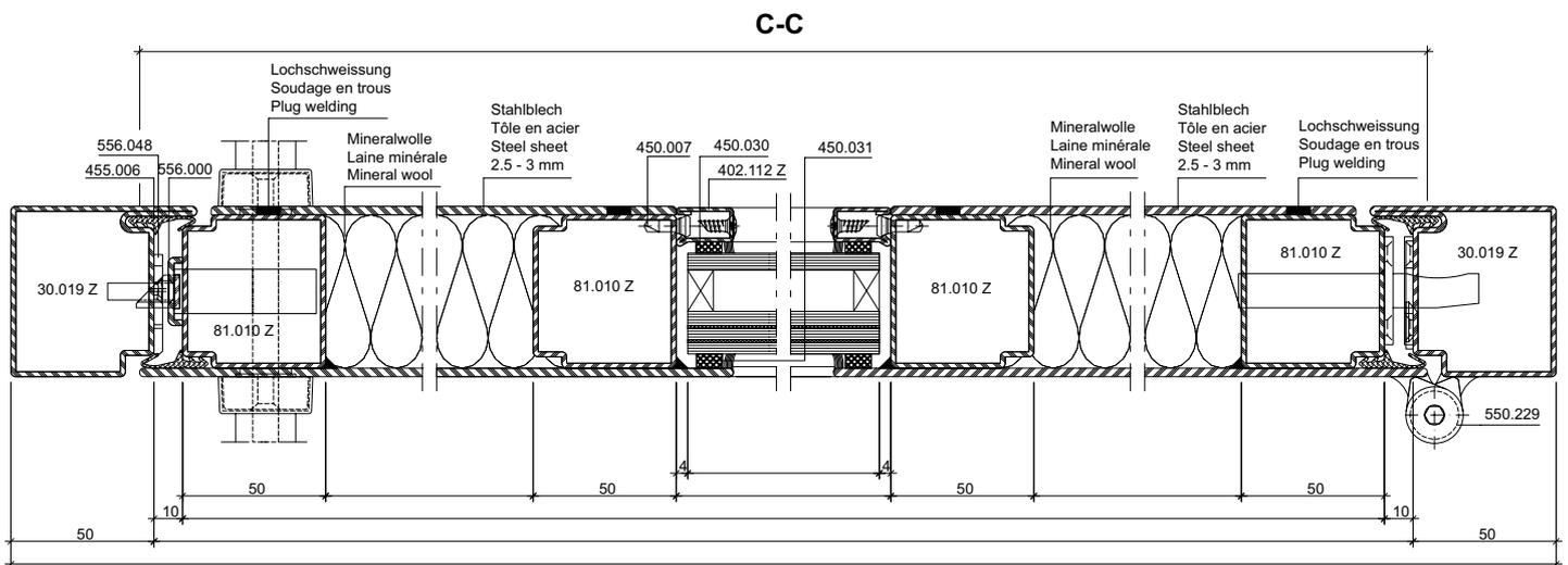
\* Verblechter Blendrahmen in Kombination mit Standard- oder verblechtem Türflügel ist mit Anschraubband (555.060-063) nicht möglich.
