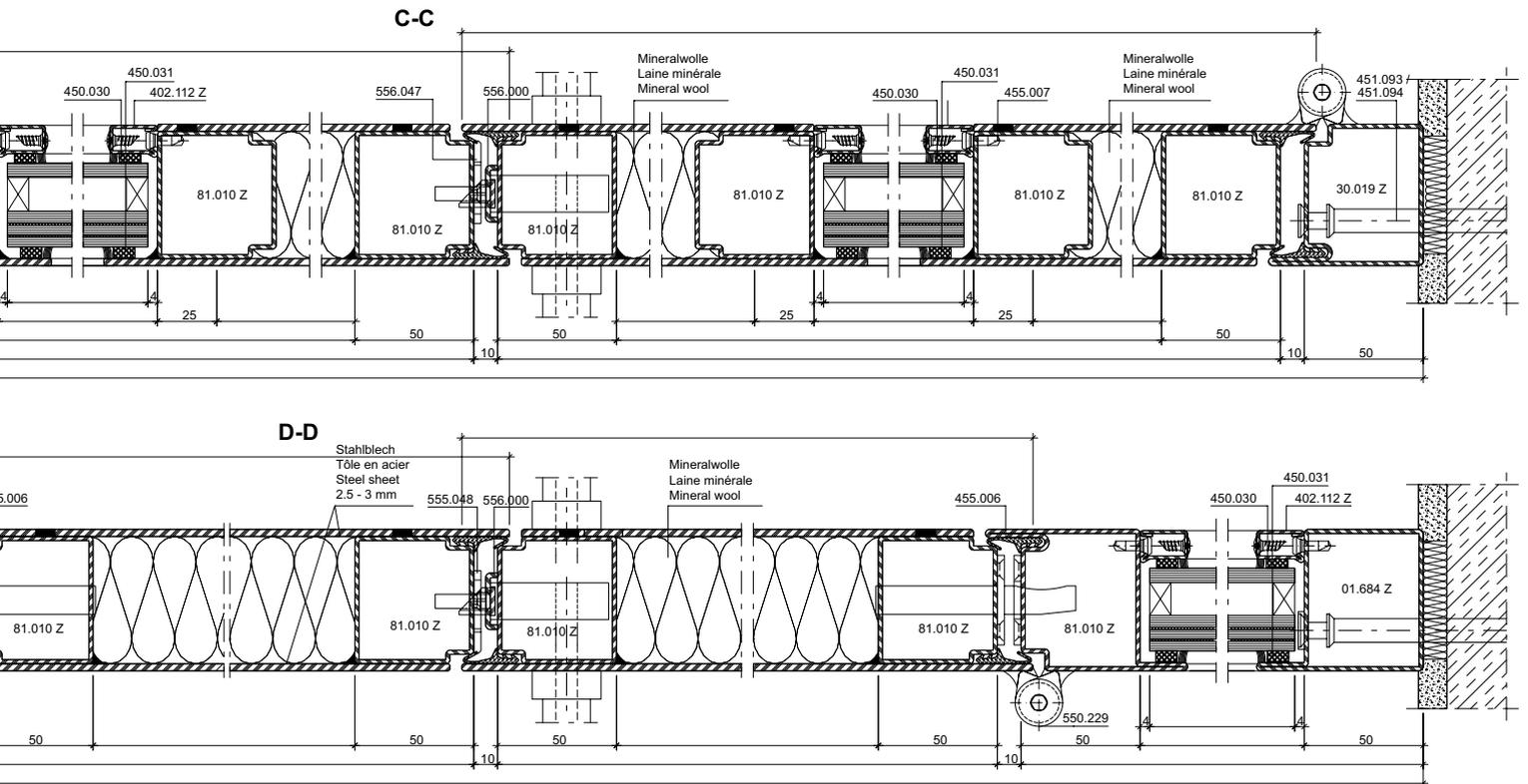
Aufgrund möglicher Deformationen von verblechten Türen in exponierten Lagen mit Sonneneinstrahlung sollte diese Anwendung nicht eingesetzt werden, ansonsten ist eine Beschattung vorzusehen.
