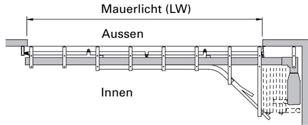
Toranlage beidseitig öffnend, Antrieb rechts
