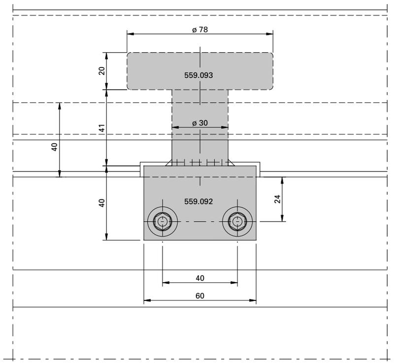
Einbau Laufwerk oben
