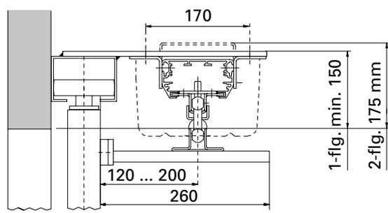
Minimaler Platzbedarf bei Montage an die Führungsschiene 150 mm (1-flügeliges Tor) und 175 mm (2-flügeliges Tor).
