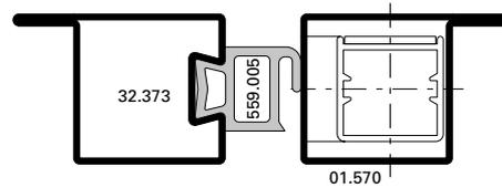
**Einbau Dichtung m-25
