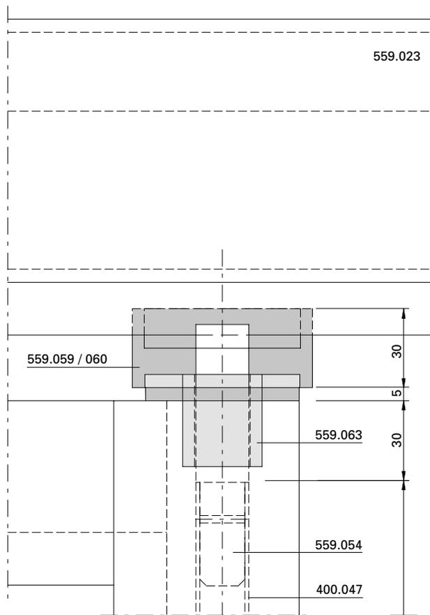
**Einbau Stangenverschluss unten mit Schwellen-T 559.027**
