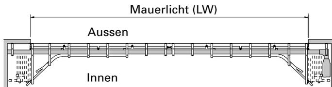
Toranlage beidseitig öffnend, Antrieb links
