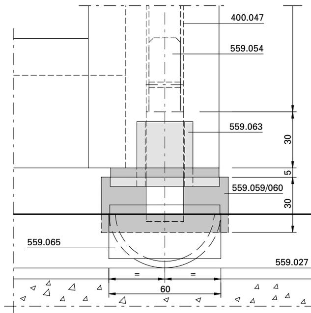
Einbau Stangenverschluss unten mit
