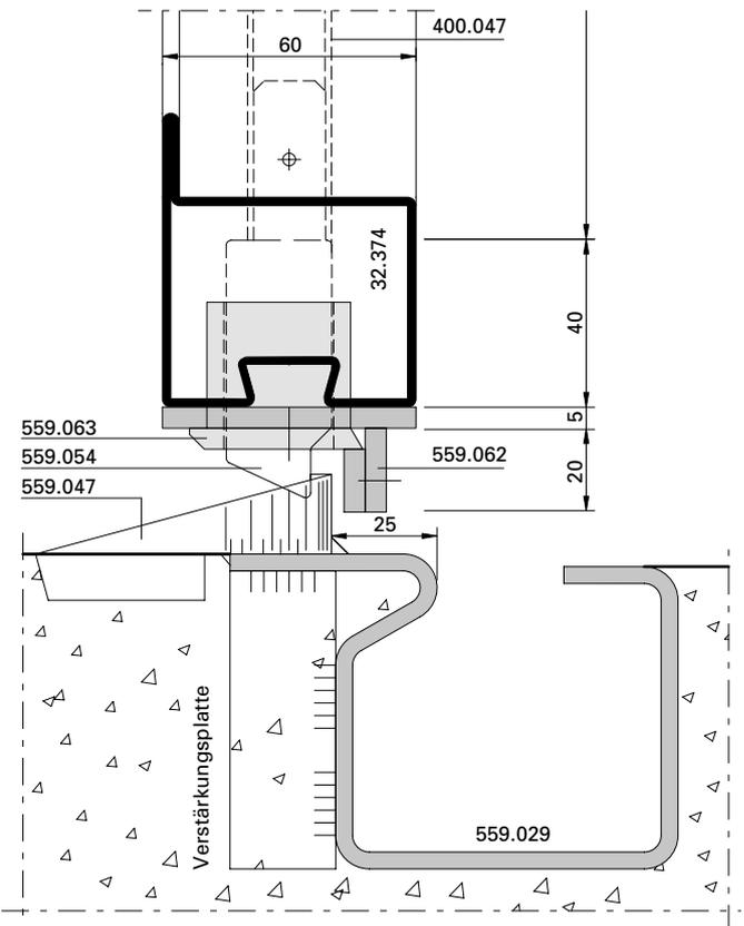
**Einbau Stangenverschluss unten mit Schwellenrohr 40/30/3 (nur für Typ 2+0, 2+1, 2+2)**
