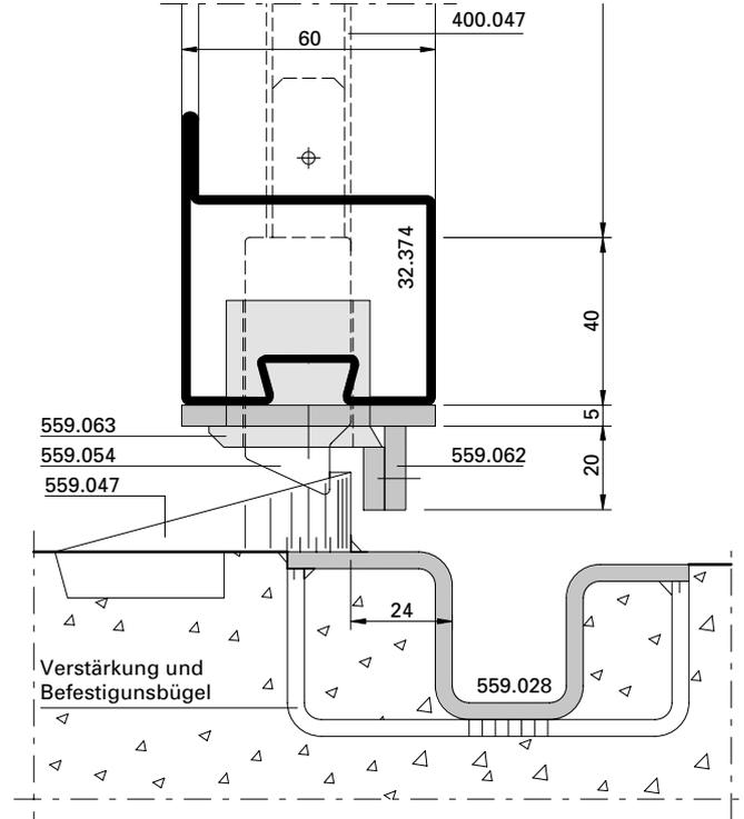
Einbau Stangenverschluss unten mit
